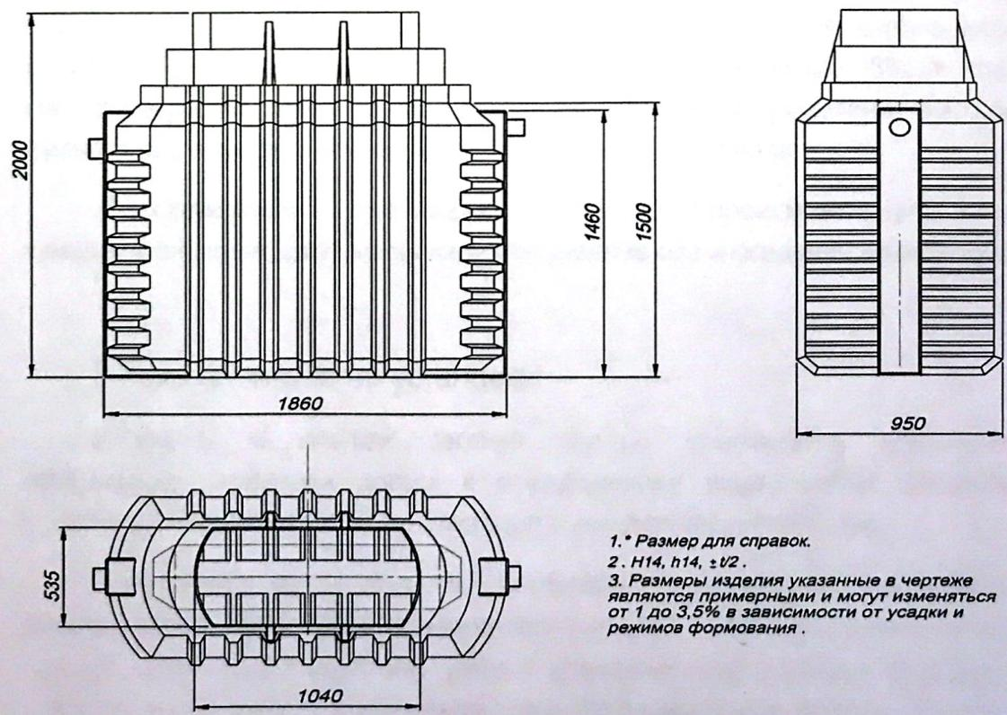
*Примечание: габаритные размеры изделий из полимеров имеют допуски ±3%, в зависимости от температуры окружающей среды. Параметры продукции могут иметь технологические погрешности при изготовлении. Производитель имеет право вносить изменения в технические характеристики моделей продукции и их документацию без предварительного уведомления.*
